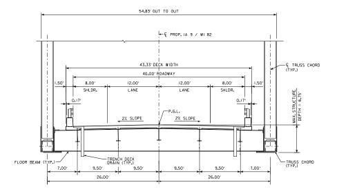
TYPICAL TRUSS SECTION AT NAVIGATION CHANNEL
